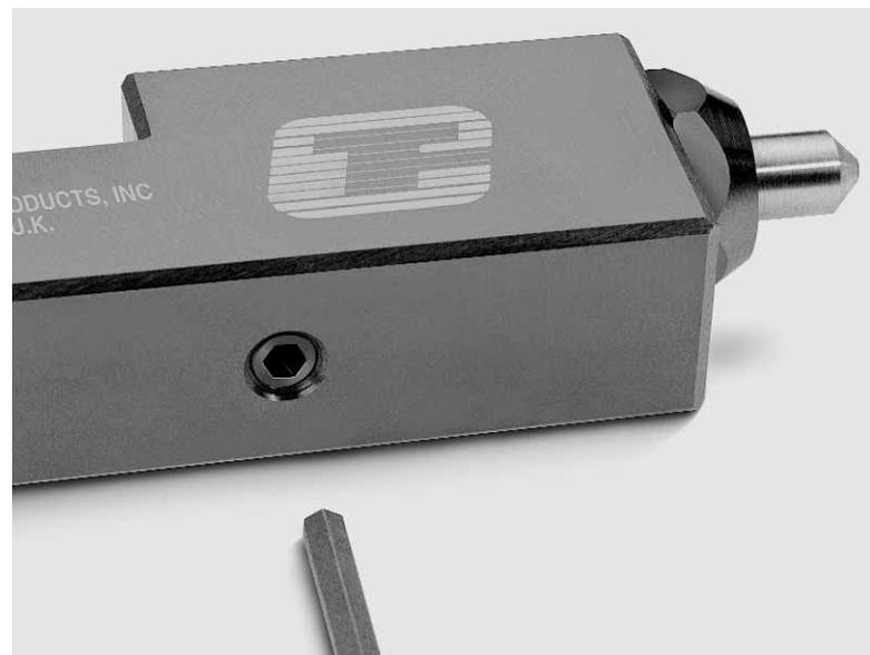
Les brunissoirs diamantés sont réglables afin d'obtenir la pression d'utilisation idéale. Pour les modèles DB-1 et DB-2, la vis de réglage se situe à l'extrémité de l'outil. Pour les modèles DB-3 et DB-4 la vis de réglage se situe sur le côté de l'outil.
